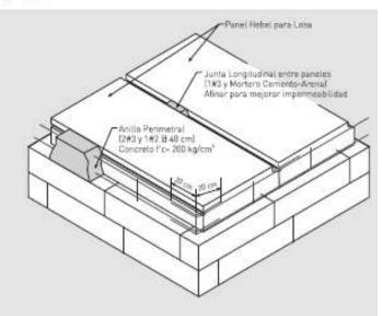
Fig. 14: Juntas longitudinales y anillo perimetral.
