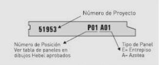
Fig. 2-Identificación de Panel Hebel para losa.
