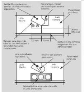
Fig. 15: Colocación de tuberlas y salidas en losa-
