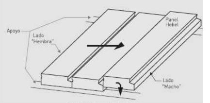
Fig. 12: Dirección de instalación de paneles.
