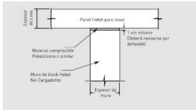
Fig. 17: Aislamiento de muros divisorios (No Cargadores).
