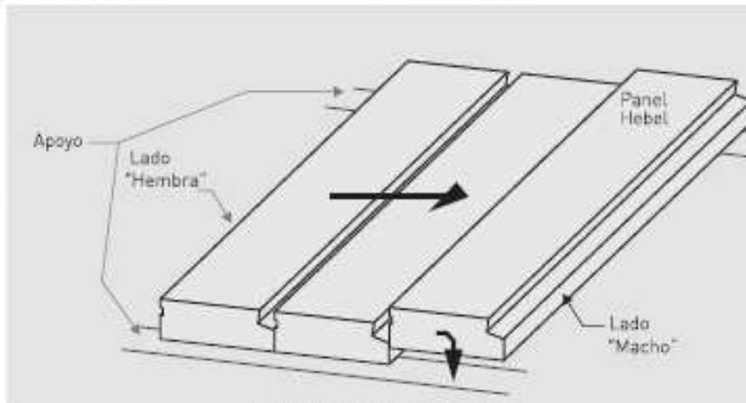
Fig. 12: Dirección de instalación de paneles.
