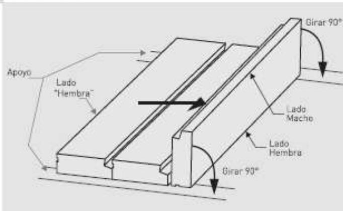
Fig. 9: Dirección de instalación de paneles
