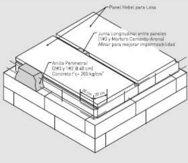
Fig. 14: Juntas longitudinales y anillo perimetral.
