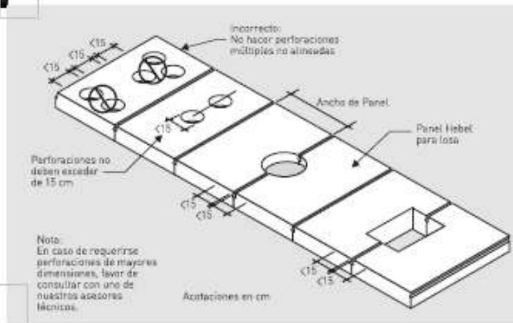
Fig. 19: Dimensiones máximas de perforaciones en panel Hebel para losa.
