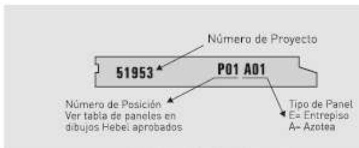
Fig. 2- Identificación de Panel Hebel para losa.
