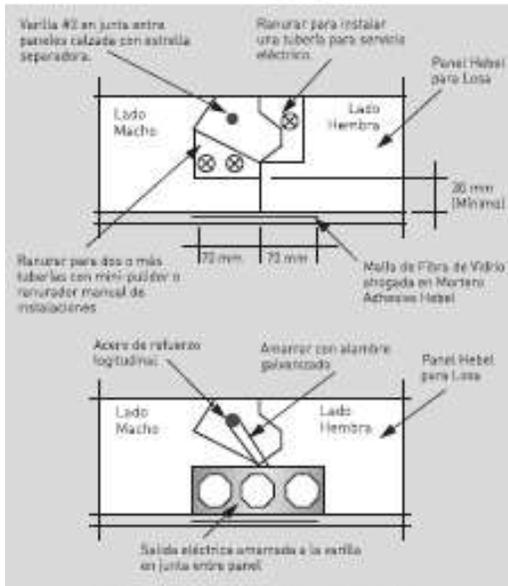
Fig. 15: Colocación de tuberías y salidas en losa.
